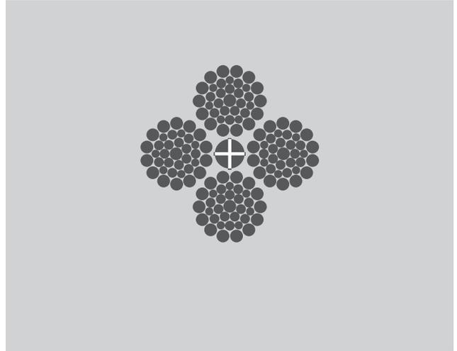
Cable galvanizado especialmente diseñado para dispositivos tiracables. Su geometría está diseñada para ajustarse a este tipo de dispositivos, evitando la formación de cocas o torceduras que pudieran provocar fallas en el mecanismo interno.
